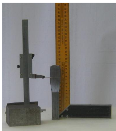
Рис. 4. Способ нанесения рисок на образец
