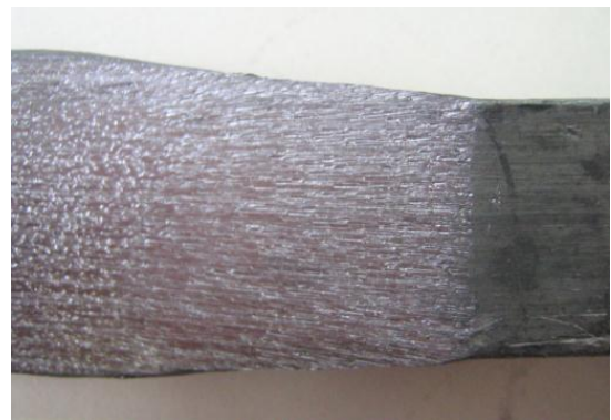
Рис. 7. Образец-недокат со следами контакта с валком (вид сверху)
